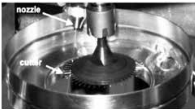
شکل ۷- فرآیند ساخت میکروکپسول به روش خرد کردن جت (تکنولوژی جت کاتر) [۳].
